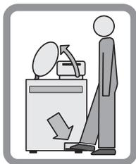
La puerta se abre pisando un pedal situado en la parte delantera inferior derecha del instrumento. La puerta está abisagrada en la parte trasera izquierda para abrirse con un ángulo de 60 grados con respecto a los paneles laterales de la centrífuga, dejando espacio para cargar y descargar la centrífuga.
