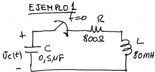
Se cierra la llave en  $t=0$  con una tensión sobre  $C$  de  $20V$  y una corriente en  $L$  de  $30mA$ .
