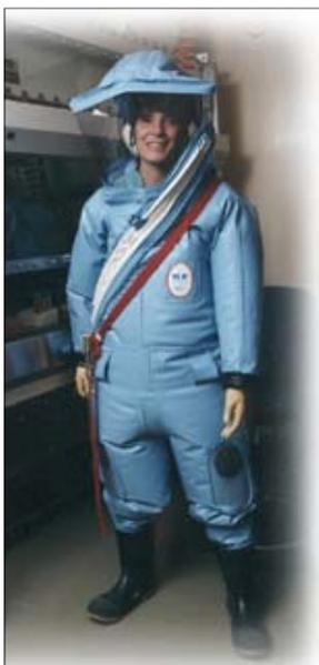
**Figura 6. Traje para personal BSL-4, con aire a través del espiral proveniente de la parte superior del casco**
