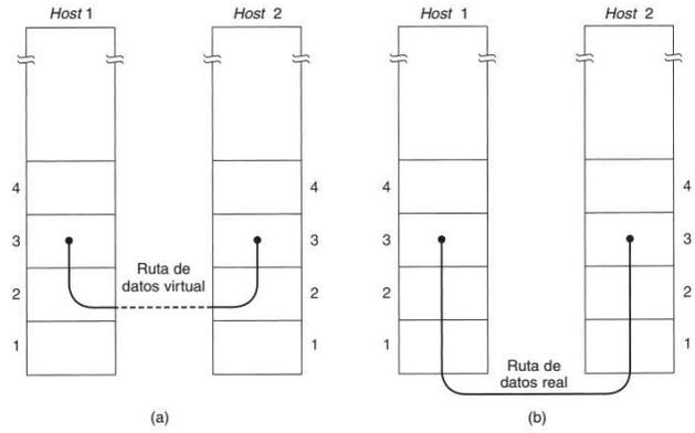
Figura 3-2. (a) Comunicación virtual. (b) Comunicación real.
