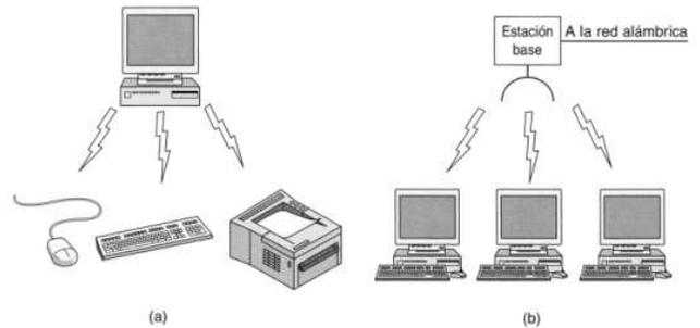
Figura 1-11. (a) Configuración Bluetooth. (b) LAN inalámbrica.
